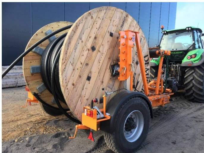
Mynd 3.4 Strengkefli á keflavagni sem notað er við lagningu jarðstrengs.
